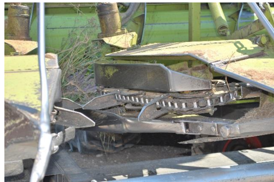
Ill. 9. Détail des ciseaux de l'ensileuse. © Chloé Rosati-Marzetti, 2018.
