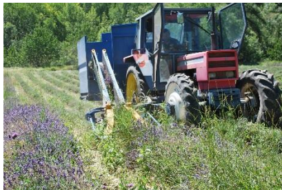
Ill. 2. Lavande remontant par un tapis roulant dans le caisson. © Chloé Rosati-Marzetti, 2018.
