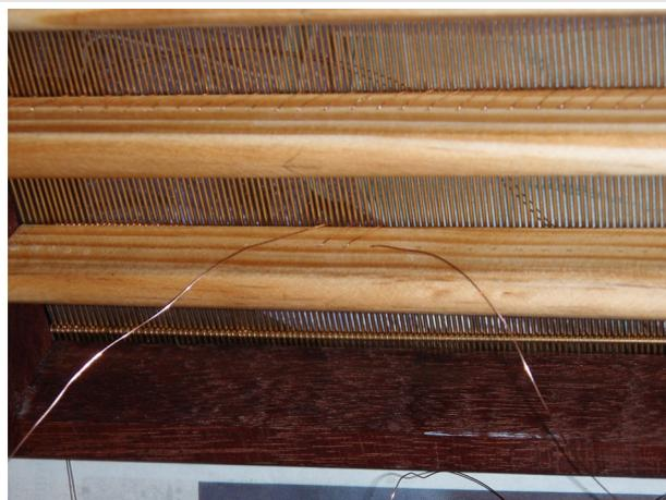
Détail arrière de la couture du plan métallique sur le châssis
