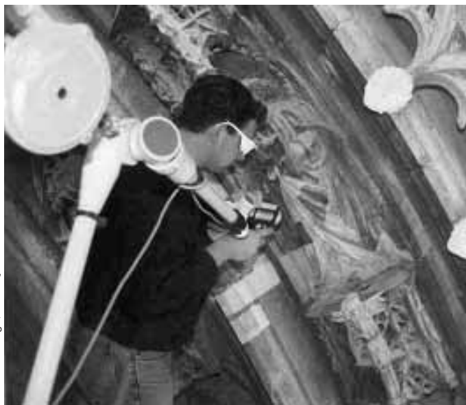
Essai de nettoyage laser sur un claveau sculpté (étude préalable à la restauration du portail nord de l'église Saint-Michel de Bordeaux).
