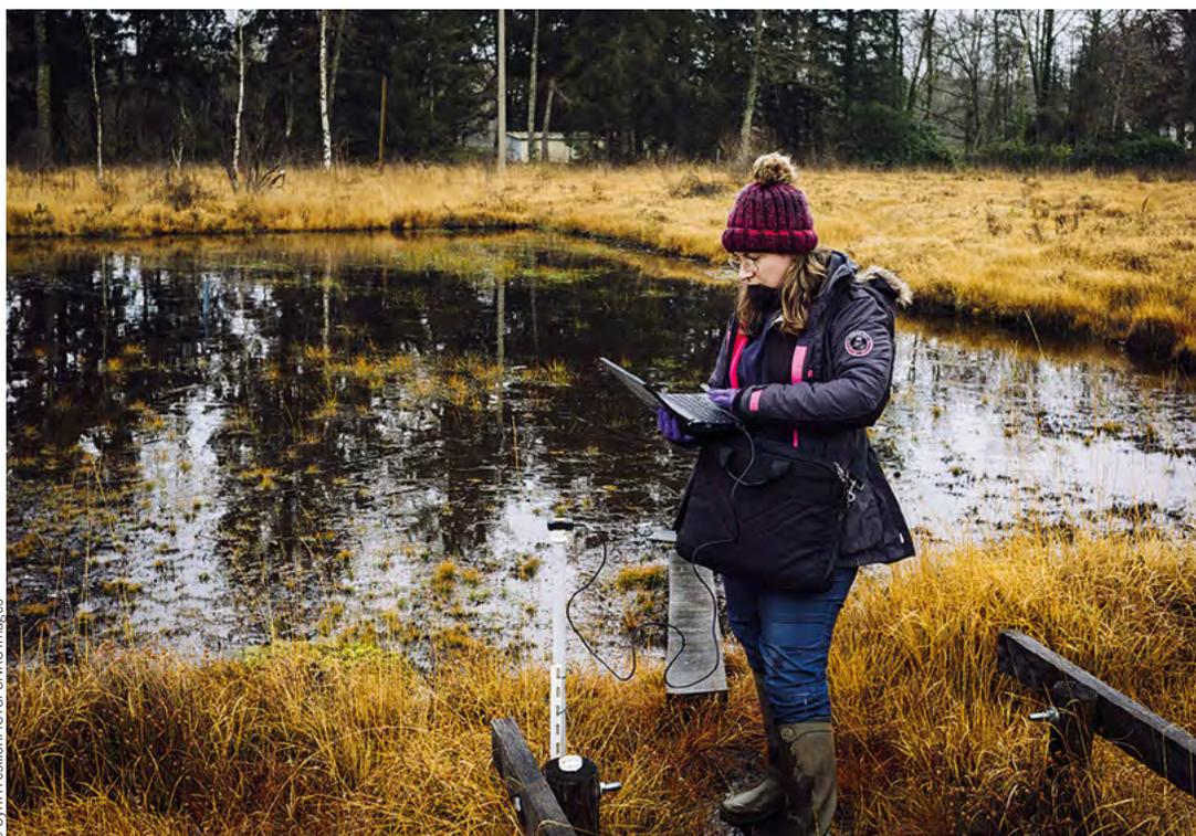
Mesure piézométrique pour connaître la hauteur d'eau à proximité d'un dispositif expérimental en aval de la tourbière de la Guette, dans le Cher. Les tourbières sont des puits de carbone mais, dégradées par les changements environnementaux, elles émettent du dioxyde de carbone et du méthane.
