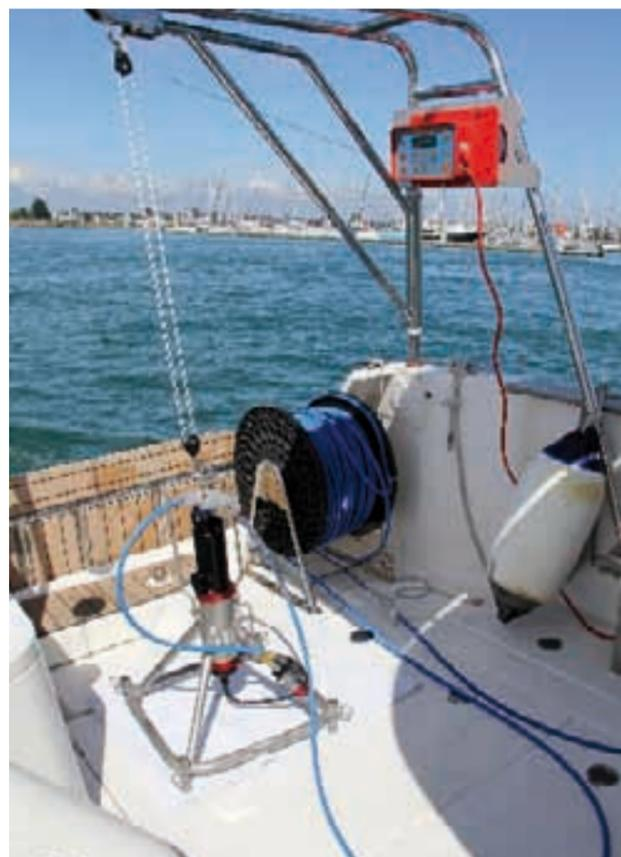
Fig. 15. Mise en œuvre du sonar Mesotech-MS-1000 depuis le *Bleizig-mor*.
