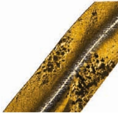
Fig. 139. Détail d'un passage au sonar entre la deuxième et la troisième anomalie, montrant les amas de blocs présents sur leurs bords, largeur de la bande de l'ordre de 20 m (relevé et traitement D. Degez/Drassm).
