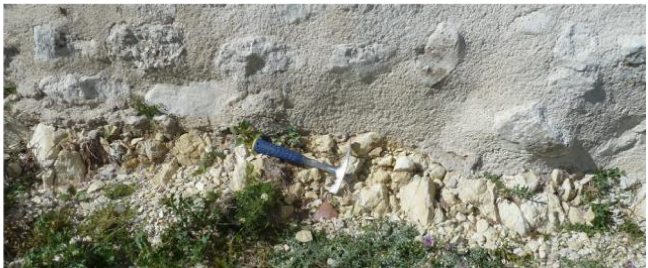
Vues de mise en œuvre des calcaires argileux beige-clair-verdâtre à patine légèrement rousse (Turonien), très altérés, affleurant au-droit de l'église.
