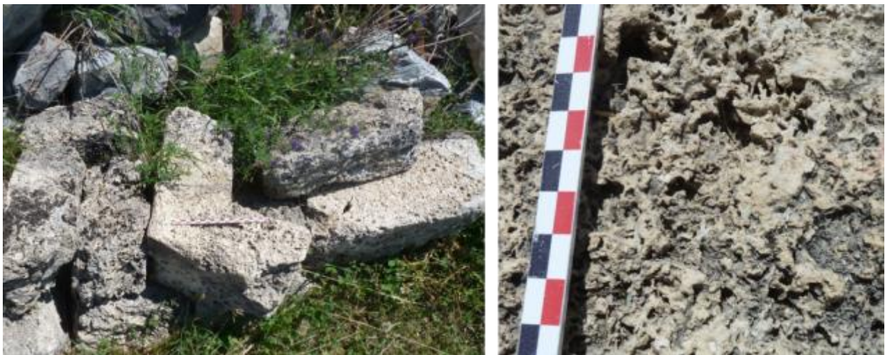
Vues de blocs déposés de tuf de source beige très vacuolaire à patine beige-grisâtre.
