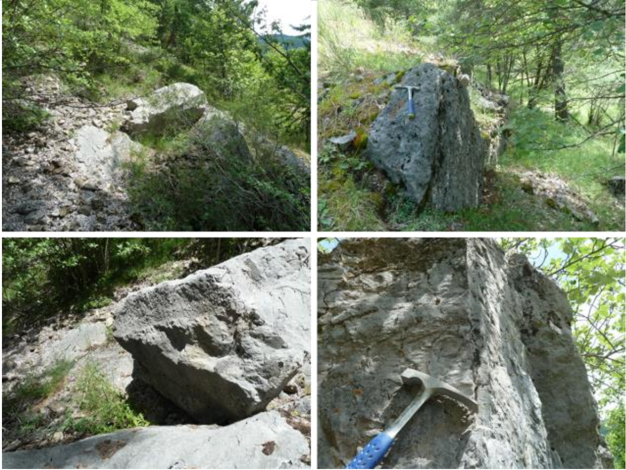
Vues de la zone d'exploitation (hameau de Chaumie) des blocs de calcaire dur noirâtre à pâte fine (marbrier) entrecoupé de veines éparses blanches de calcite, issus des falaises sus-jacentes (Flysch à helminthoïdes du Sénonien-Paléocène).
