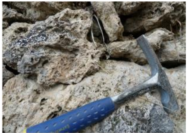
Vues de la carrière de provenance des calcaires noirâtres à patine gris-bleuté mis en œuvre sur l'édifice.
