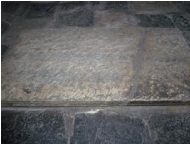
Vue de la dalle (ancienne table ?) en calcaire noduleux à éléments beige et ciments rougeâtre à verdâtre de type Vert de Serenne.
