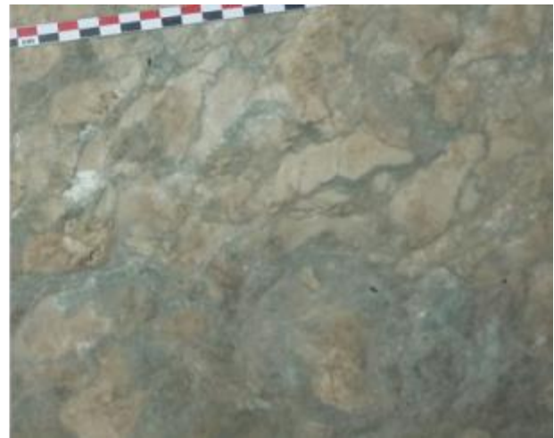
Vue de la dalle (ancienne table ?) en calcaire noduleux à éléments beige et ciments rougeâtre à verdâtre de type Vert de Serenne.
