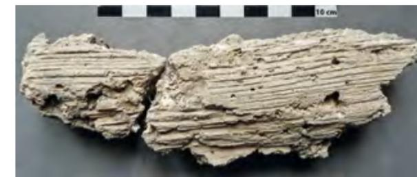
Fig. 19 – L' ARGENTIÈRE-LA-BESSÉE, Château de l'Argentière (Argenterie). Bourg castral. Détail du négatif de poutre imprimé dans le mortier et observé dans l'axe longitudinal du tronçon arasé de l'enceinte ouest (cliché B. Oury).
