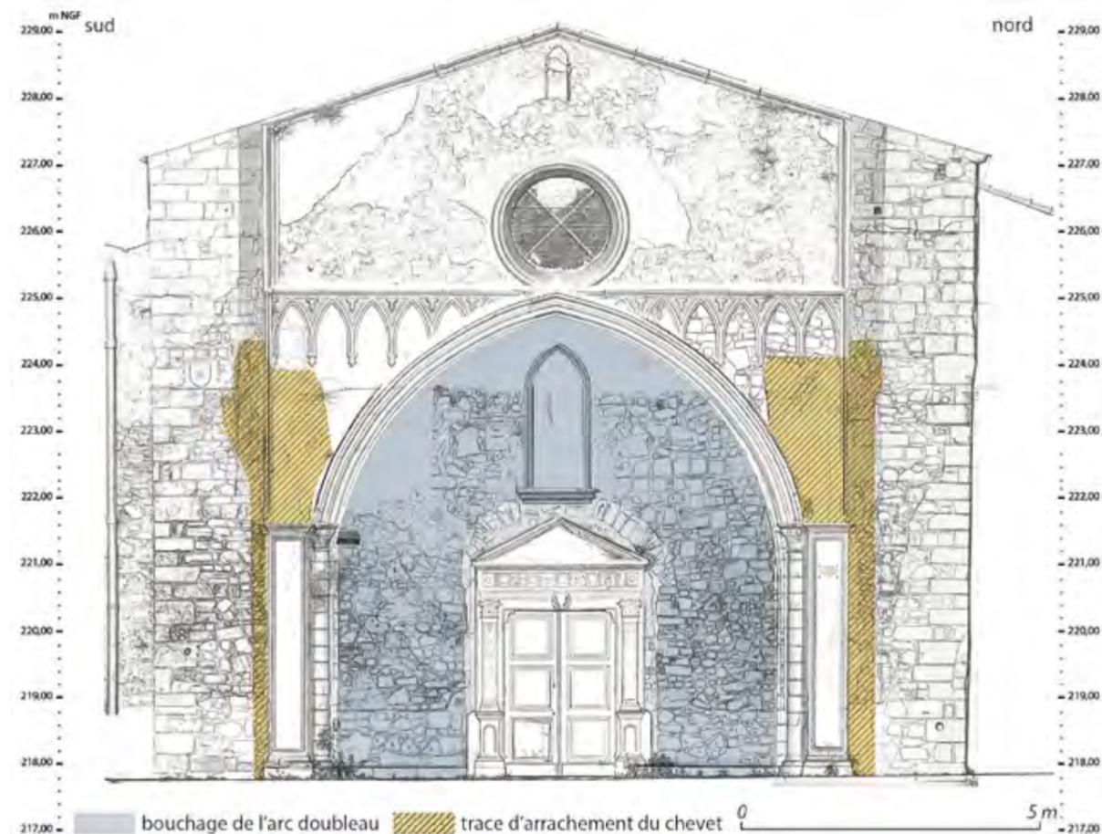
Fig. 56 – AIX-EN-PROVENCE, Chapelle Notre-Dame-de-Consolation. Relevé pierre à pierre de la façade et détails des maçonneries (DAO : M. Panneau/DAMVA).
