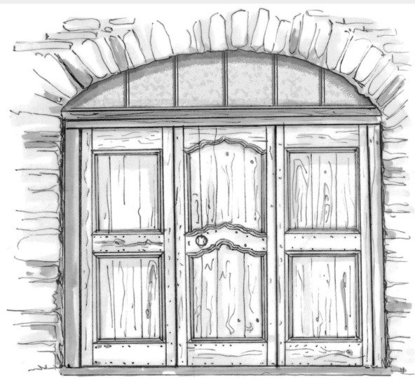
Porte de grange En planches ou à cadres
