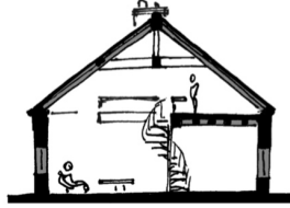
Ouverture de l'espace (étage en mezzanine)
