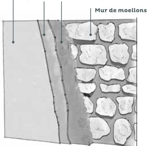
Les 3 couches d'un enduit à la chaux
