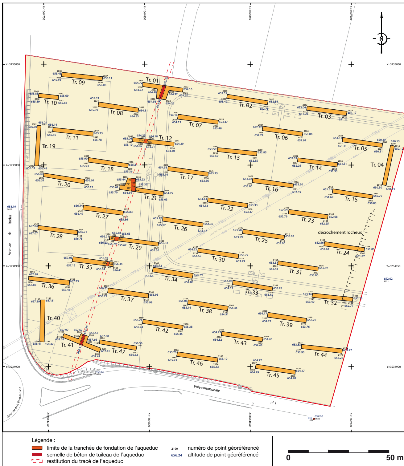
Luc-La-Primaube, La Boissonnade. Implantation des tranchées du diagnostic et matérialisation du tracé de l'aqueduc antique (relevé : Cabinet Bois ; DAO : N. Albinet, SDA de l'Aveyron).
