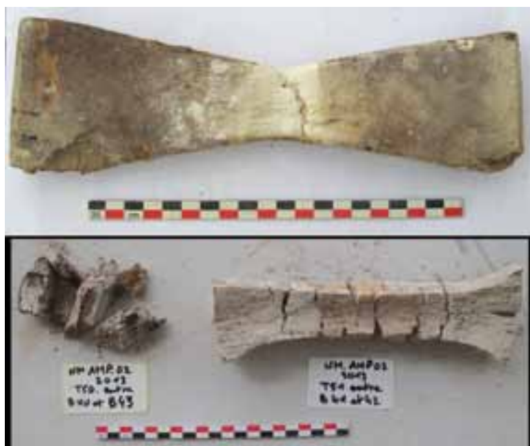
Fig 3 : doubles queues d'aronde en chêne en différents états de conservation
