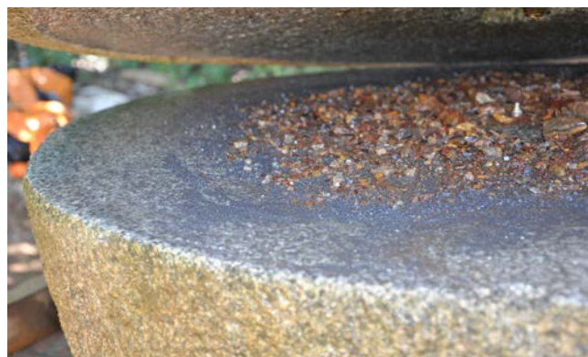
Melle, PCR paléométaballurgie expérimentale, minerai de plomb argentifère en cours de pulvérisation entre les meules (Cliché : F. Téreygeol)
