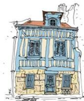
> **Hauteur de soubassement** : Dans une région où l'humidité est aussi importante, il est rare de constater des hauteurs de soubassement inférieures à 0,4 ou 0,6 mètres. Cette protection aurait été insuffisante pour permettre à l'édifice de parvenir jusqu'à nous.
