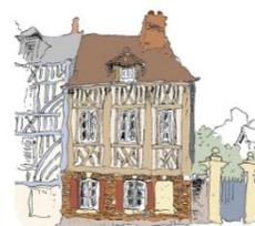
> **Soubassement** : Il a pour rôle de protéger le pan de bois de l'humidité provenant du sol (remontées capillaires). Il permet également de s'adapter à la pente et d'assurer une assise horizontale plane à la sole.
