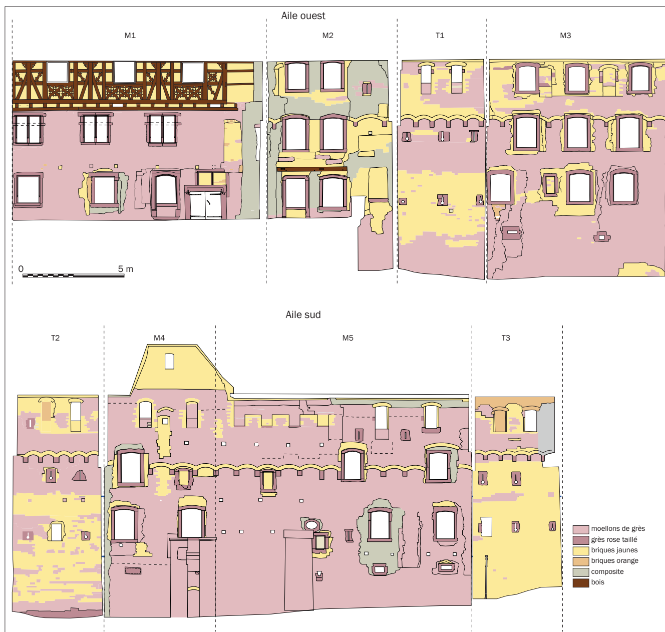
BREUSCHWICKERSHEIM, château, 1 rue du Château Relevé des façades du château de Breuschwickersheim, répartition des matériaux (cliché : L. JEANNERET)
