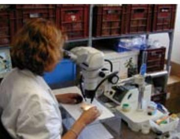
41/Tri sous loupe binoculaire des échantillons provenant des tamis fins (500 microns : 0,5 mm)
