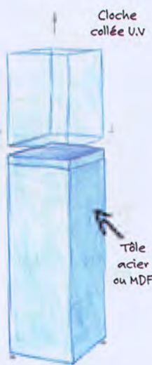
② Cloche avec ouverture par ventouse
