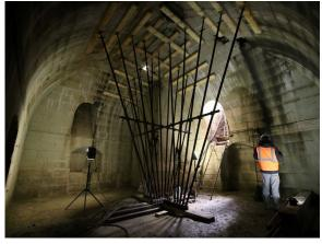
Dans le cadre du suivi archéologique des prélèvements de mortiers sont réalisés pour documenter les techniques de construction.
