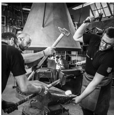
Technique de forge à trois marteaux, 30 juillet 2019. © Fabrice Bourdeau / Garde républicaine, 2019.
