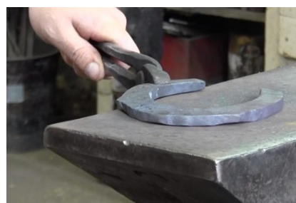
Ill. 18. Outil de forge : enclume, tenaille de forge et fer à cheval, 31 juillet 2019. © Magueye Thioub. Anne-Sophie Rieth, 2019.
