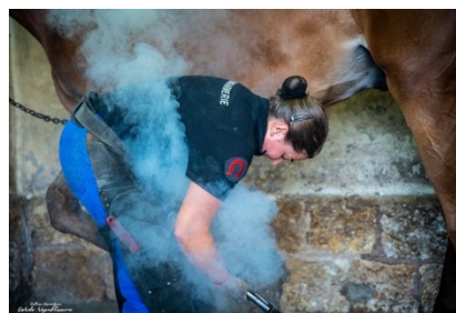
Ill. 11. Ajustage du fer à chaud, 31 juillet 2019. © Fabrice Bourdeau / Garde républicaine, 2019.
