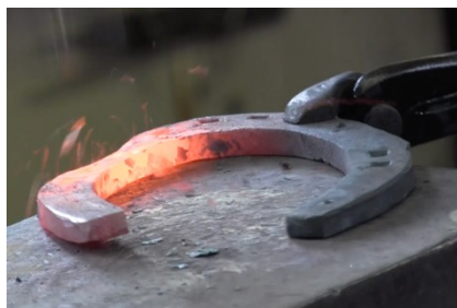
III. 1. Mise en forme de la branche externe du fer. Affinement de la forme selon la technique du bigornage, 31 juillet 2019. © Fabrice Bourdeau / Garde républicaine, 2019.
