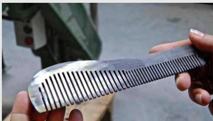
*III. 6. Les étapes de finition d'un peigne : perlage, ponçage et polissage (entreprise Azéma-Bigou).
