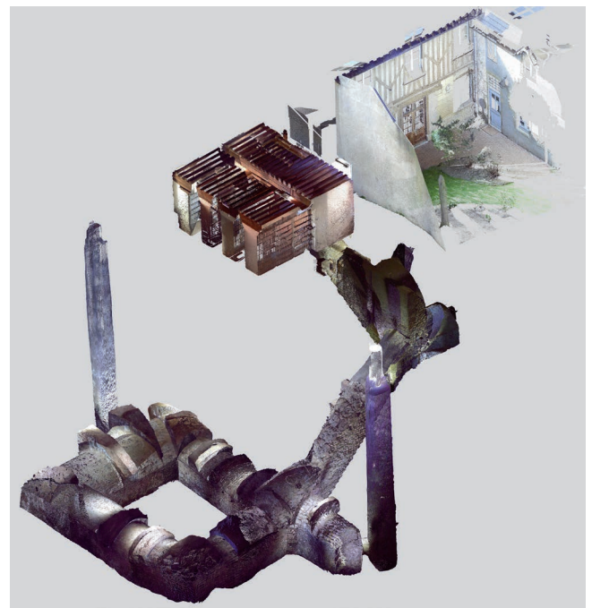
Orléans (Loiret), caves intra-muros : vue 3D vers le nord-ouest de la cave à trois niveaux sous la maison canoniale n° 21 rue Saint-Étienne / 6 place du Cardinal-Touchet (SICAVOR n° 130) : cellier à plafond, cave à voûtes d'arêtes, cave-carrière à pilier tourné et voûtes en berceau (XII e -XVI e s.) (relevé et DAO Daniel Morleghem)
