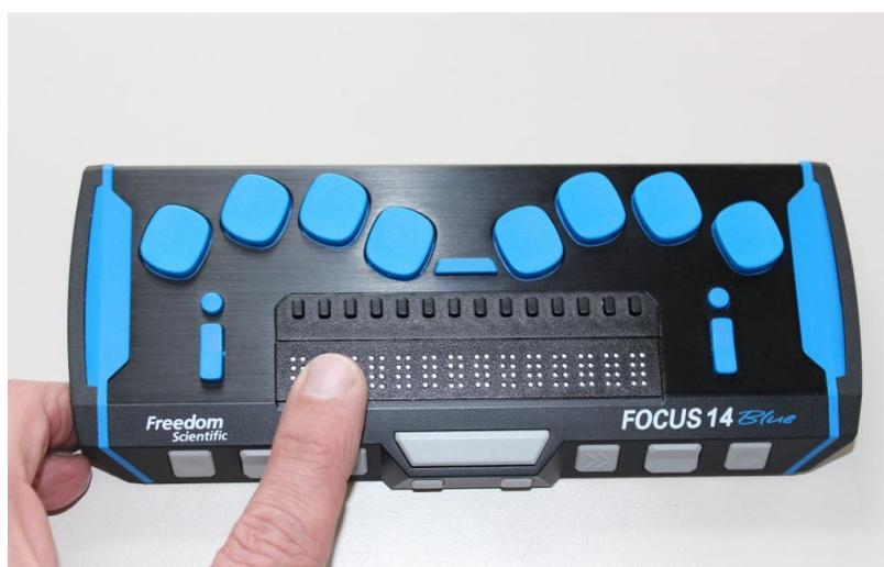
Ill. 13. Un appareil de prise de note de type Focus 14. À noter la capacité de lire avec une cellule à 8 points dite « braille informatique » et les huit touches de frappe (les petits carrés supérieurs). Ce matériel est proposé dans le catalogue du centre de recherche de l'association Valentin Haüy. © Libre de droits
