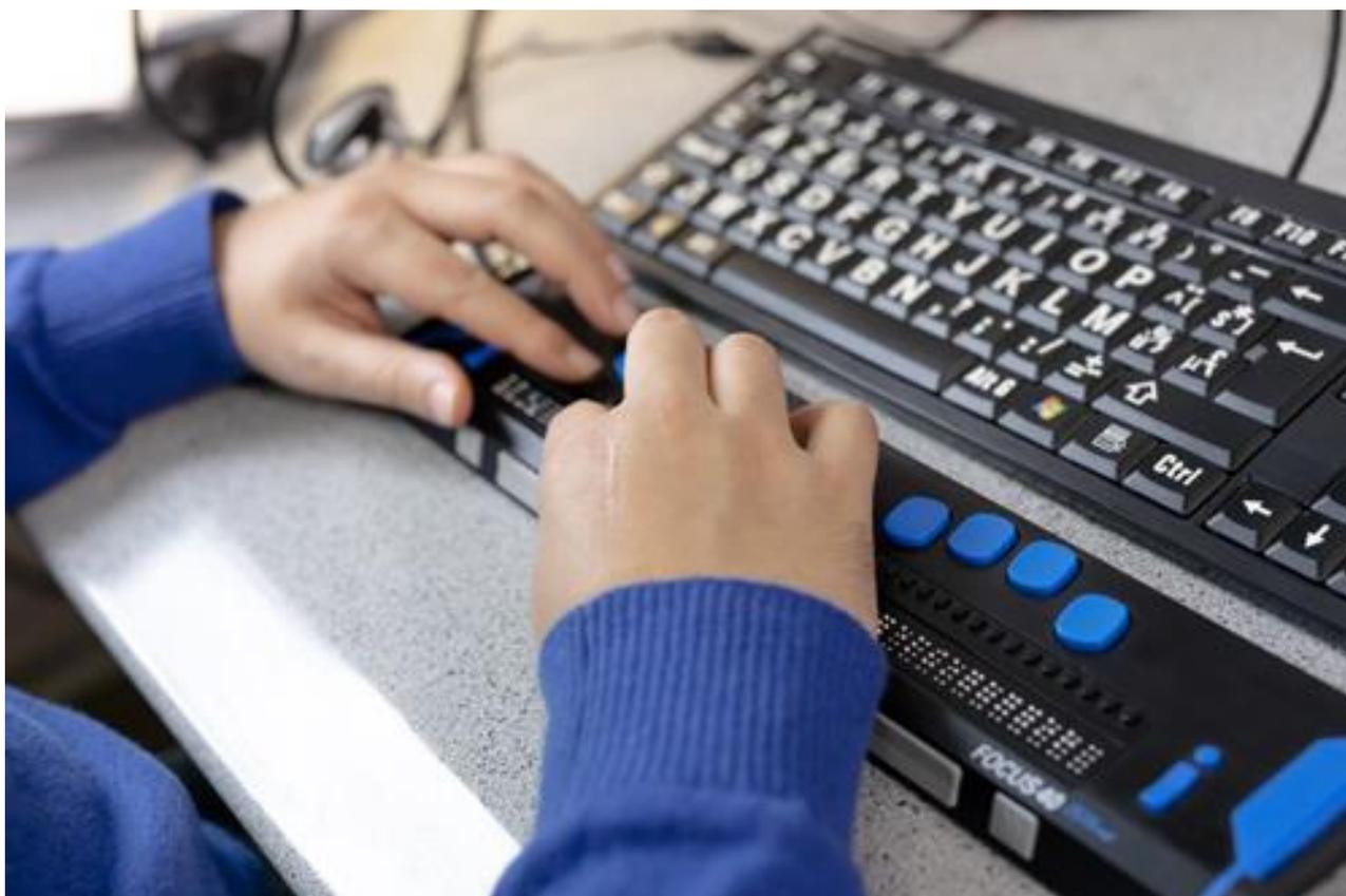
Ill. 14. Ordinateur avec clavier braille intégré. À noter le clavier ordinaire de type « AZERTY » avec des repères en gros caractères, couplé avec une plage braille de type Focus composée de cellules en braille informatique de huit points. © Site Web la ligue braille en Belgique. © Libre de droits
