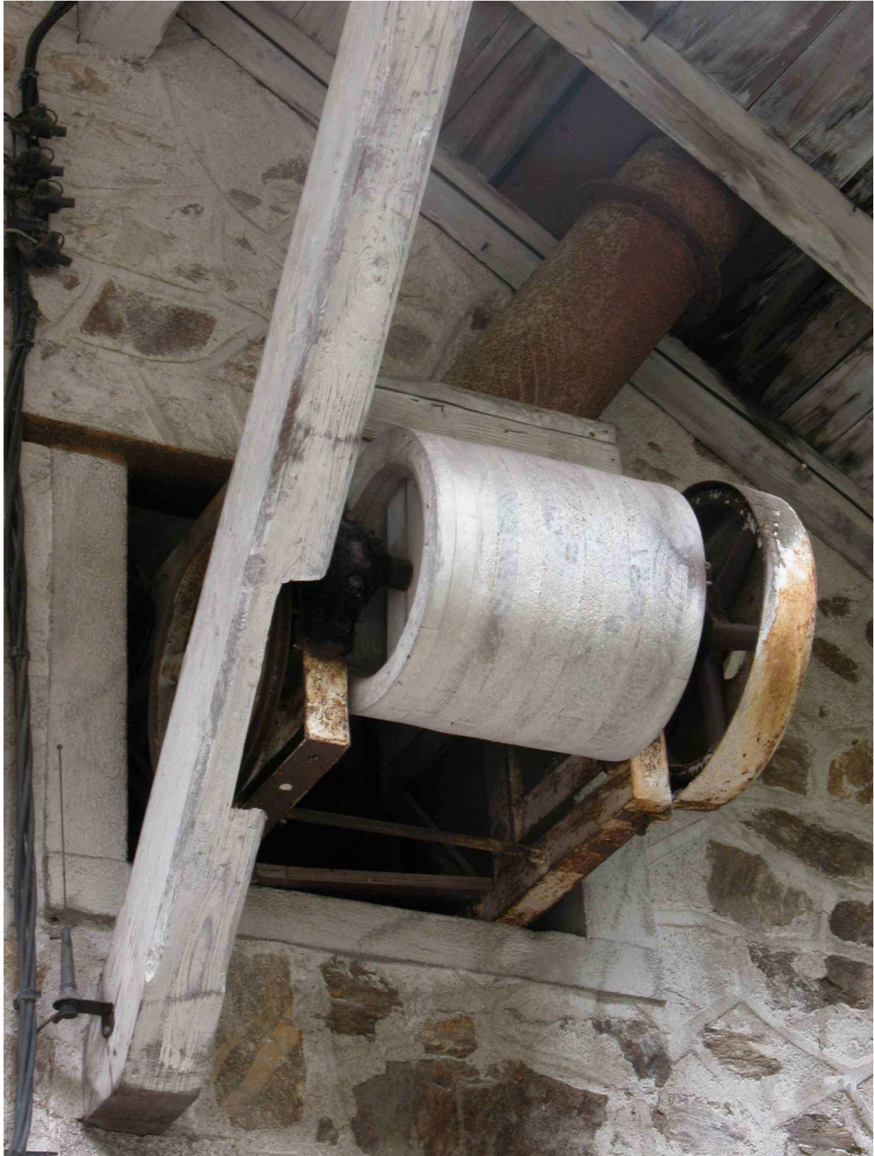
Fig.9 Un ancien atelier en bordure du CD 11 : détail d'une transporteur à bande.
