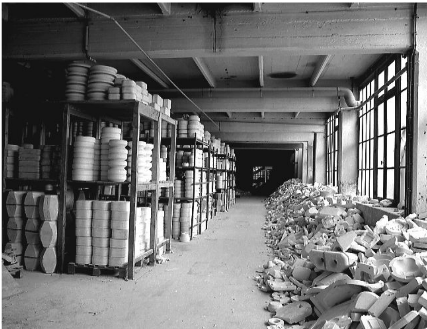
Fig.5 Le rez-de-chaussée des ateliers de 1927-1931 : stockage des moules en plâtre pour le coulage de porcelaine, en cours de tri après la fermeture de l'usine.
