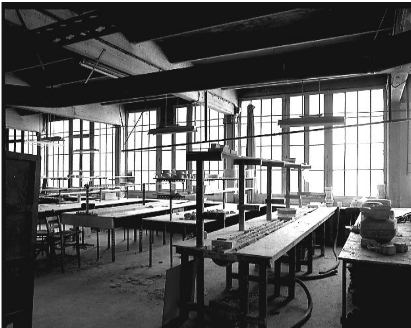
Fig.6 Atelier de coulage de l'usine de porcelaine : tables de coulage.
