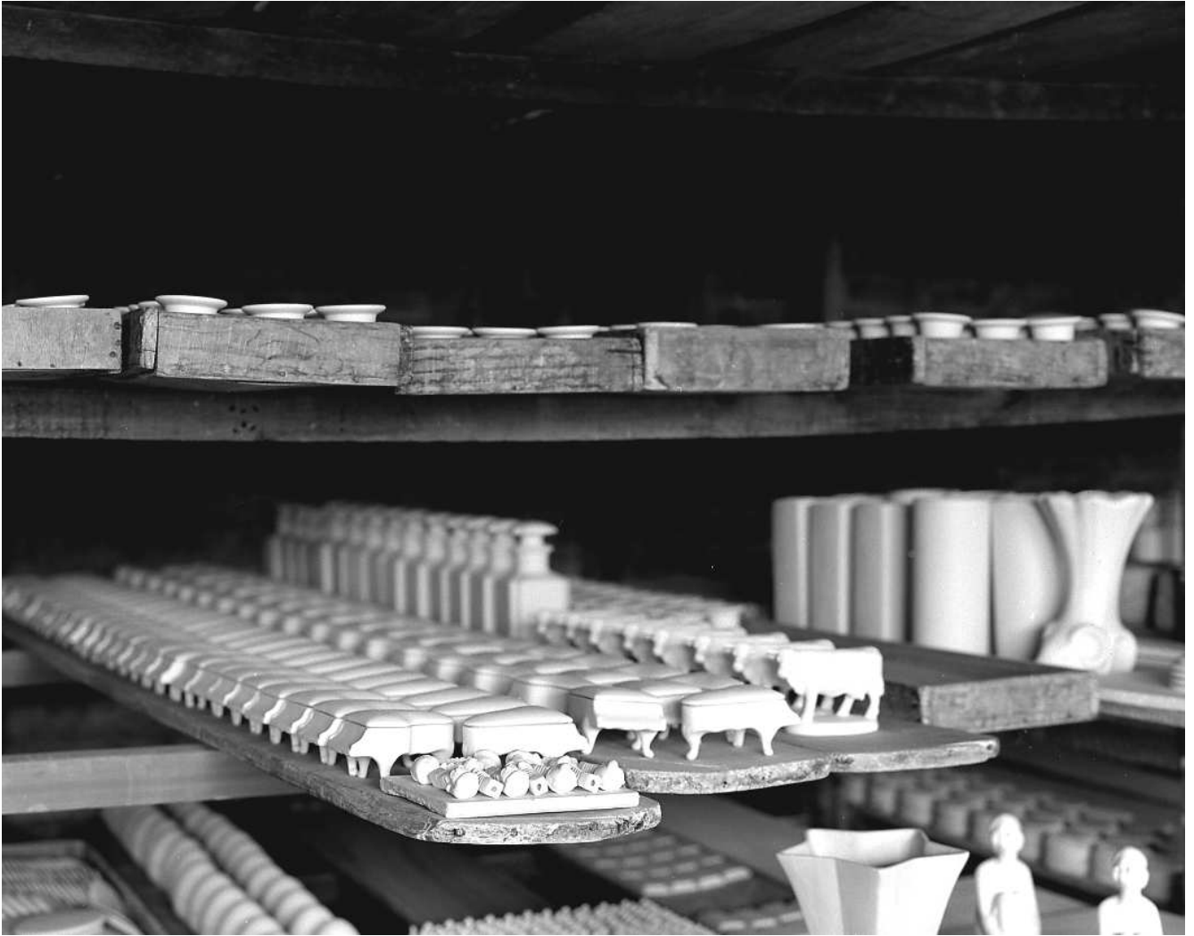
Fig.16 Séchage de pièces avant cuisson au four à dégourdi, et de pièces dégourdies avant cuisson de l'émail.
