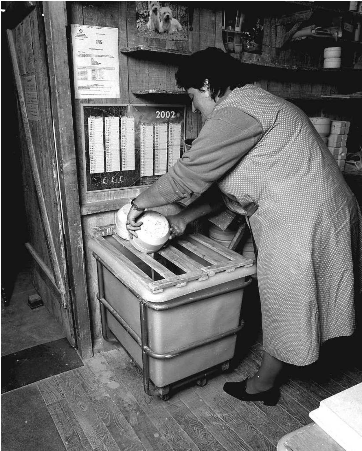
Fig.4 Opération de coulage "à ciel ouvert" d'un beurrier : rejet de l'excédent de barbotine contenu dans le moule en plâtre, et mise en place pour l'égouttage (30 minutes).
