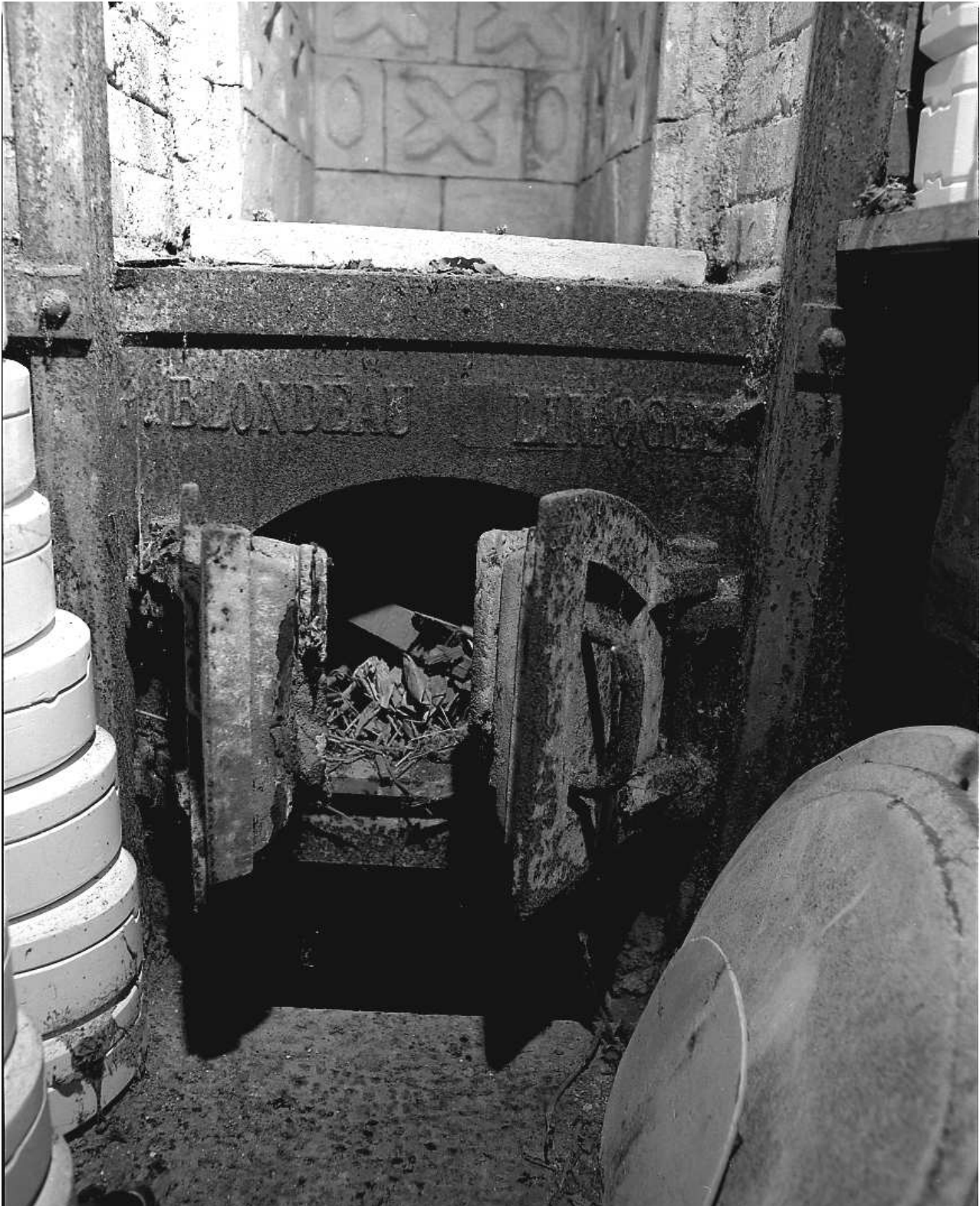
Fig.25 L'ancienne moufle (four pour la cuisson des décors) : détail du foyer et de l'inscription du constructeur ("P. Blondeau Limoges").
