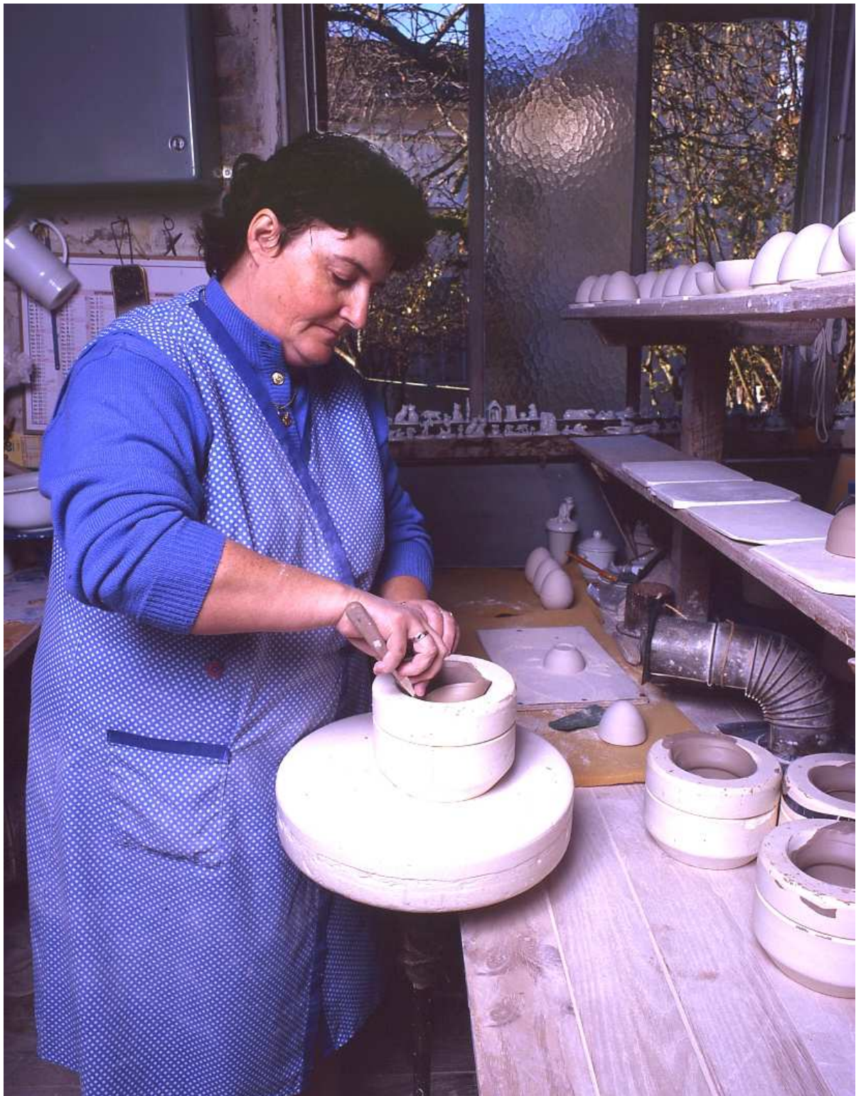
Fig.5 Opération de coulage "à ciel ouvert" d'un beurrier : après la "prise" (séchage de 30 minutes après l'opération de coulage proprement dite), enlèvement de la pâte des bords du moules, avant démoulage.
