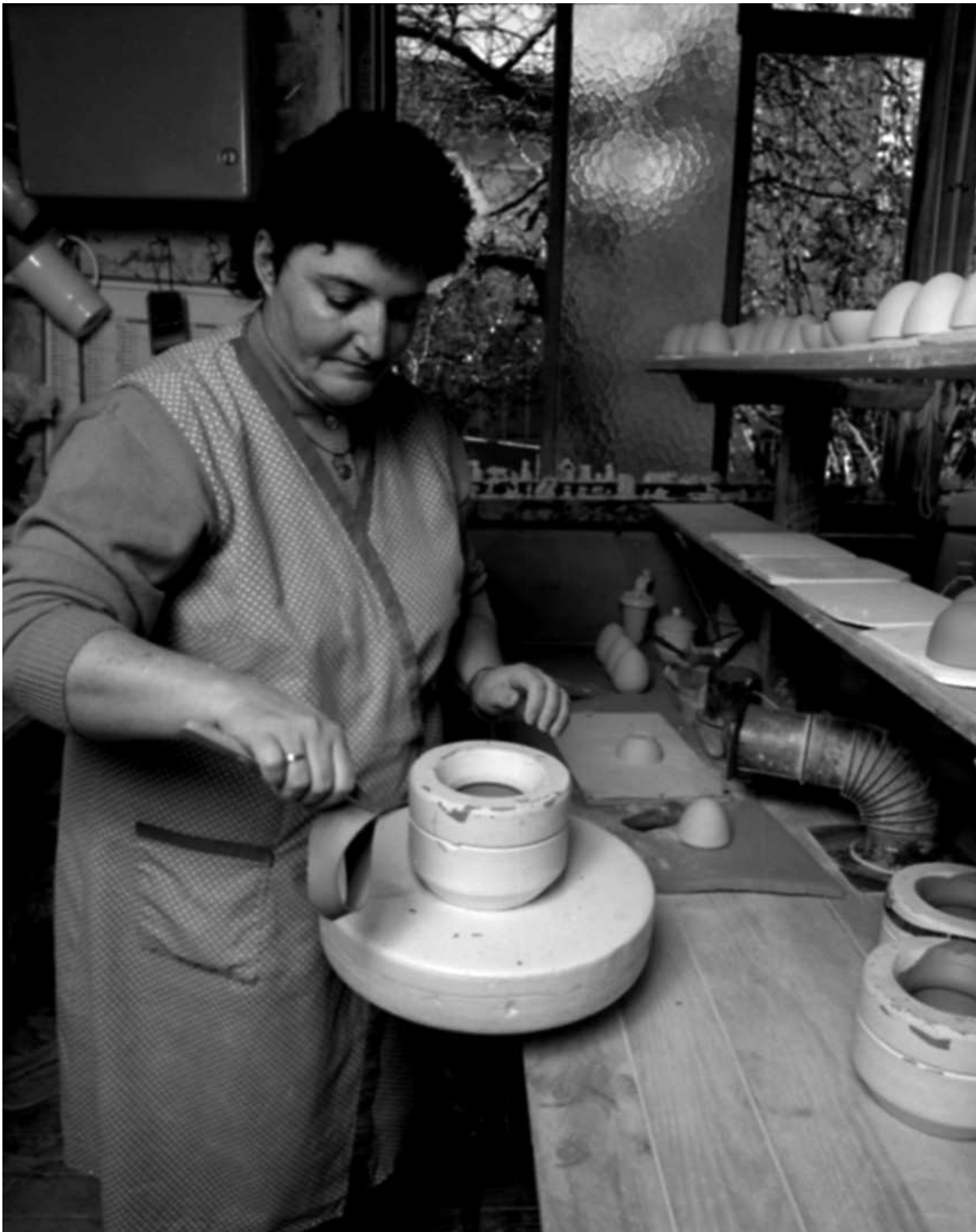
Fig.6 Opération de coulage "à ciel ouvert" d'un beurrier : après la "prise" (séchage de 30 minutes après l'opération de coulage proprement dite), enlèvement de la pâte des bords du moules, avant démoulage.
