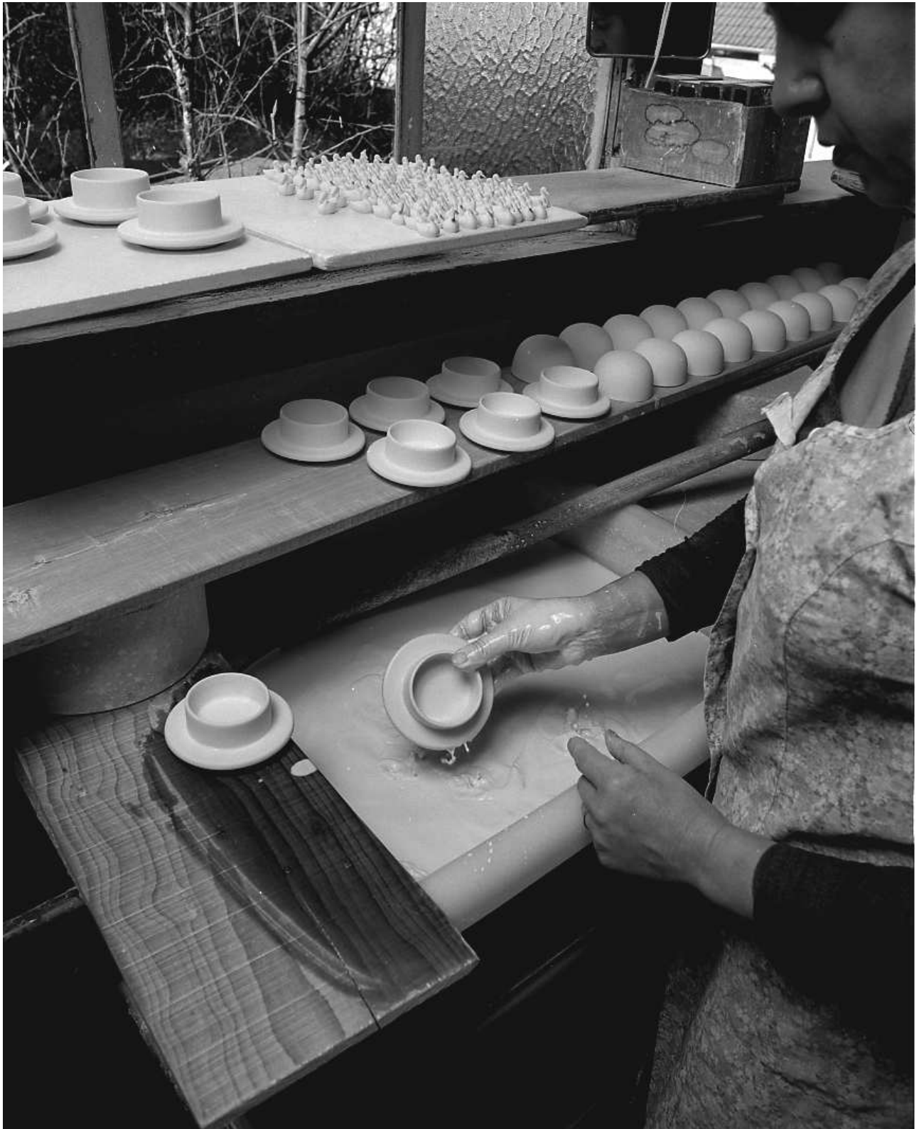
Fig.12 Emaillage des pièces constitutives d'un beurrier : la base (en cours d'émaillage), le couvercle et son motif à coller (canard).
