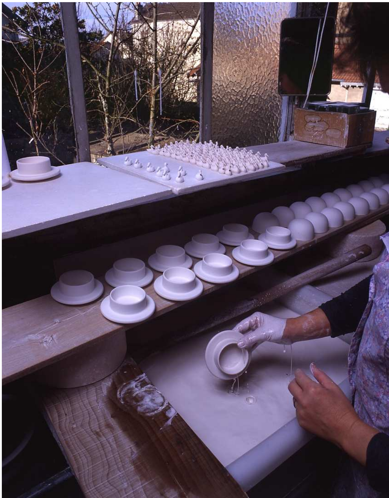
Fig.13 Emaillage des pièces constitutives d'un beurrier : la base (en cours d'émaillage), le couvercle et son motif à coller (canard).
