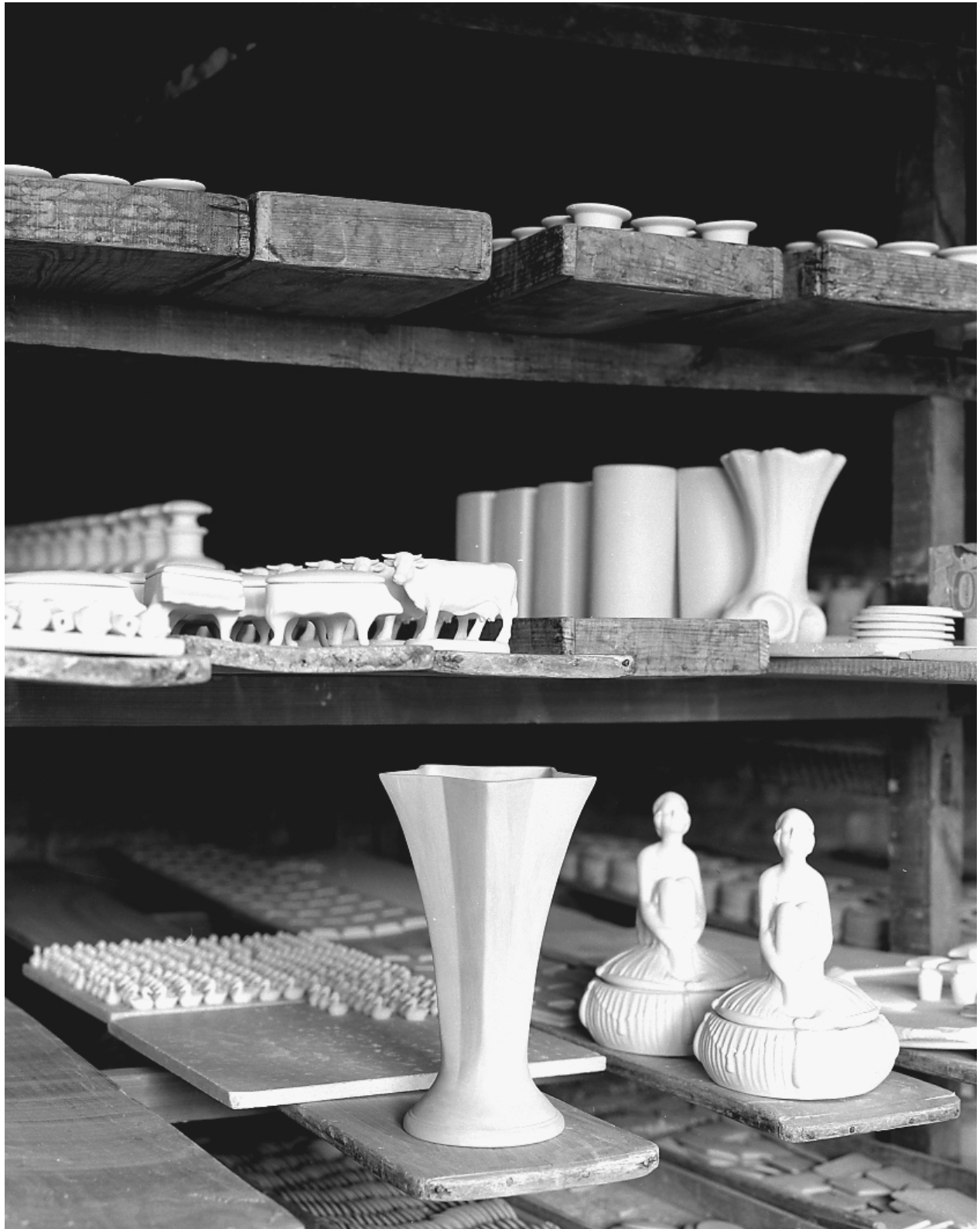
Fig.17 Séchage de pièces avant cuisson au four à dégourdi, et de pièces dégourdiées avant cuisson de l'émail.
