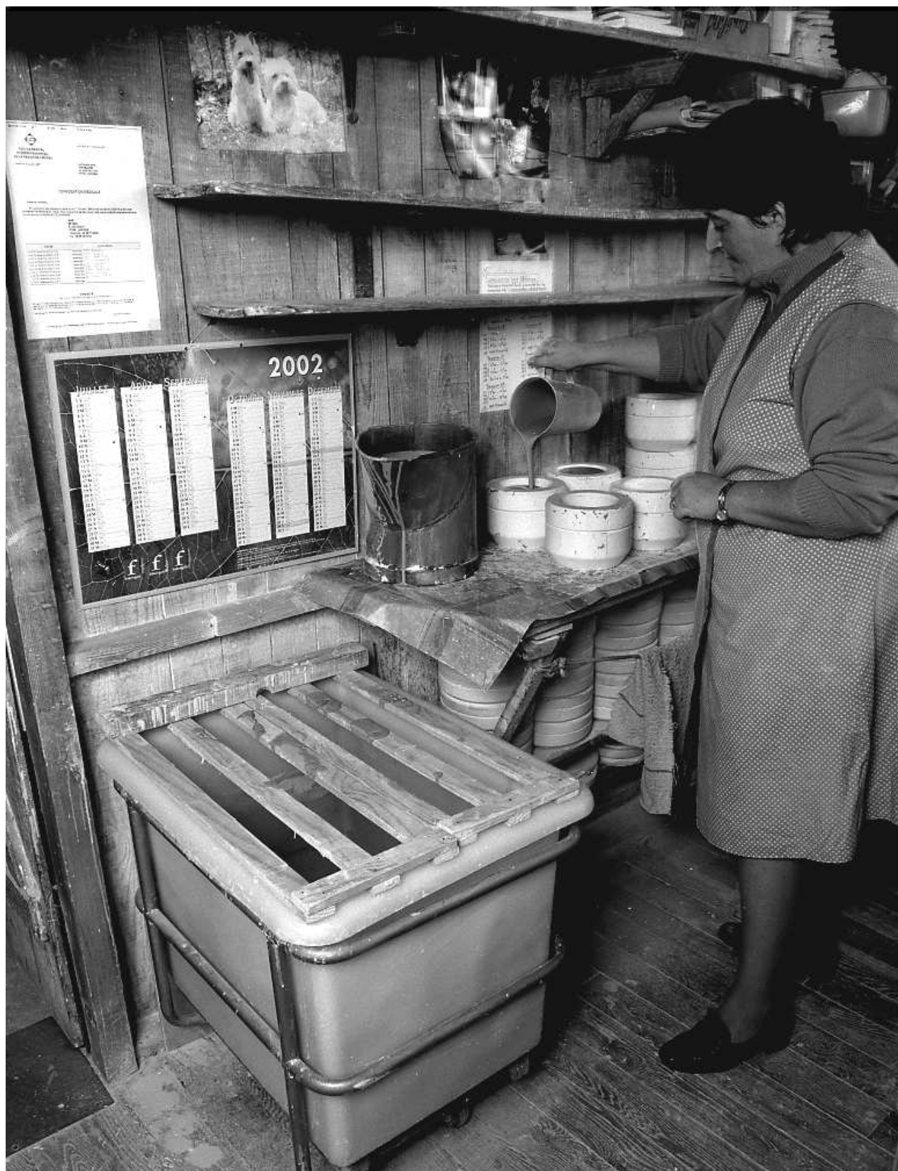
Fig.3 Opération de coulage "à ciel ouvert" d'un beurrier : versement de la barbotine dans le moule en plâtre à l'aide d'une gâche.
