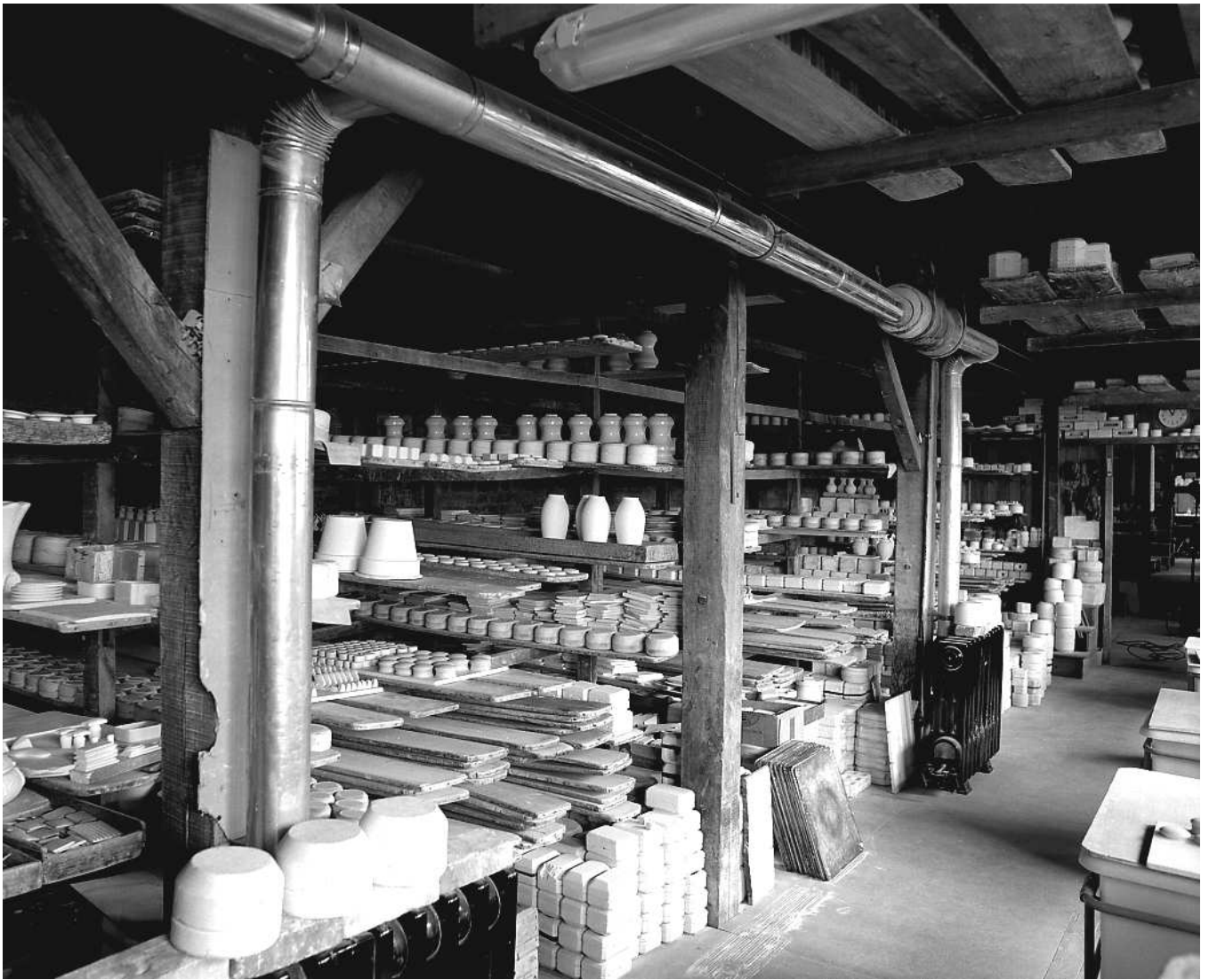
Fig.15 Atelier de fabrication : espace réservé au séchage de pièces avant cuisson au four à dégourdi, et de pièces dégourdiées avant cuisson de l'émail.
