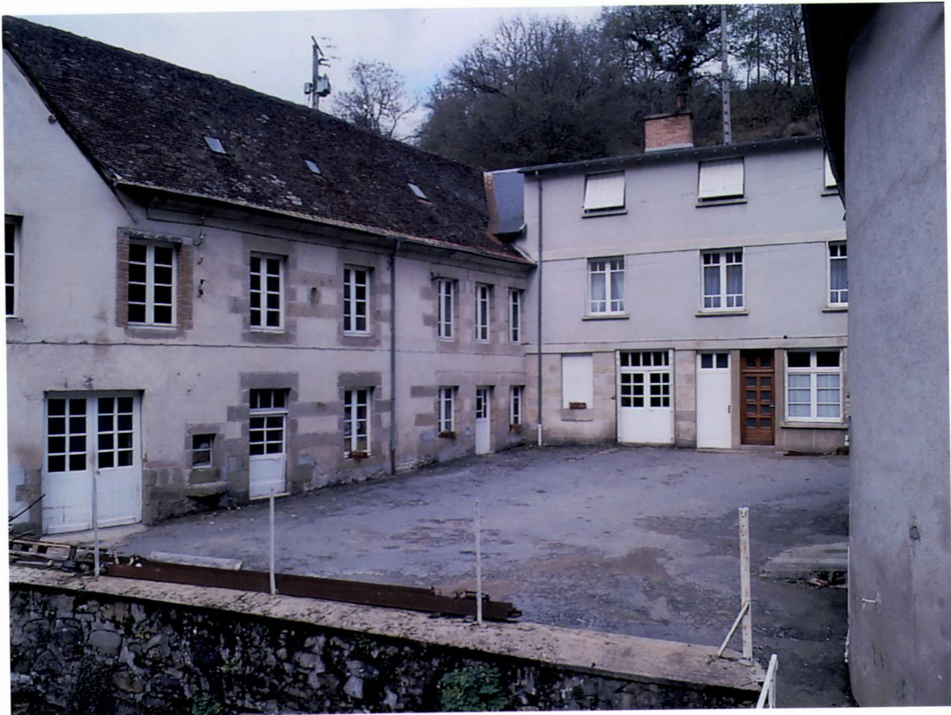
Fig. 3 Les ateliers de teinture, au sud de la cour, entre le bief et la Creuse. Le toit est percé d'un lanterneau permettant l'évacuation des vapeurs des bains de teinture.
