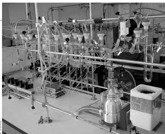
Chaîne de préparation automatisée située au centre de datation par le radiocarbone (CDRC-UMR CNRS-univ. Lyon 1 et 2) de Lyon pour les échantillons à dater par AMS (Accelerator Mass Spectroscopy) dans le cadre du projet ARTEMIS.
