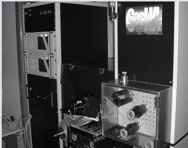
Scanner de films anciens multi-formats par immersion.
