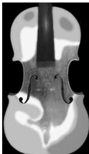
Sur le « Davidoff » d'A. Stradivari (coll. musée de la Musique), la présence de sels minéraux apportés par la sueur a été détectée par les analyses de fluorescence X.
