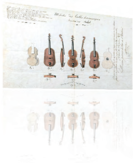
Nicolas Sulot, « Nouveau système de tables harmoniques à ondulations, adaptées sur des éclisses courbes. », 17/12/1829. Brevet français, INPI © D.R.
