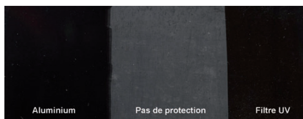
▲ Figure 5. Photographie de la surface de laques de référence multicouches appliquées sur support de bois après un vieillissement artificiel de quatre semaines, simulant une exposition de 320 ans à 50 lux (enceinte Servathin, lampe à halogénures métalliques Osram, source Atlas Solar, 1 500 W, 22 °C, 50 % d'humidité relative). © C2RMF, A.-S. Le Hô De g. à dr. : laque protégée par une feuille d'aluminium (témoin), laque exposée, laque protégée par un filtre UV ( cut-off à 400 nm).
