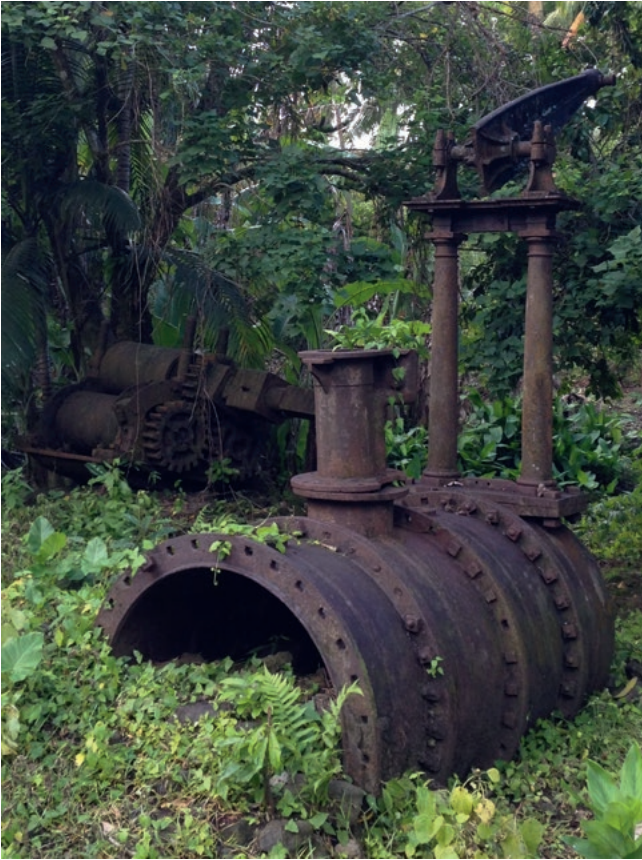
[Fig. 34b] : Vue de la chaudière du moteur à vapeur Fawcett
