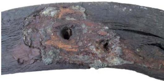
Figure 1. Efflorescence de sels sur fragment de roue (épave de Villefranche-sur-Mer). © ARC-Nucléart
