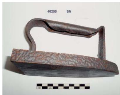
Figure 2. Fer à repasser en fonte après nettoyage par microsablage et avant application des produits à tester.
