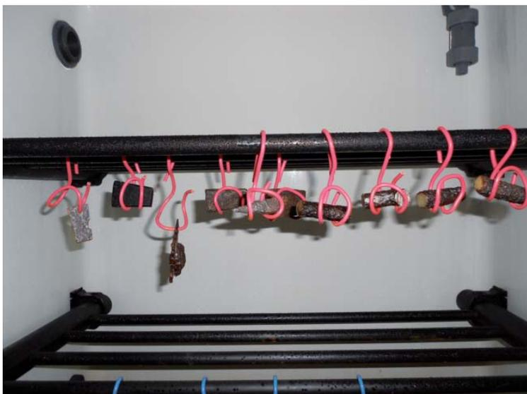
Figure 1. Agrafe archéologique en fer forgé découpée en fragments. Les éprouvettes sont placées en chambre climatique avec et sans application de l'inhibiteur.
