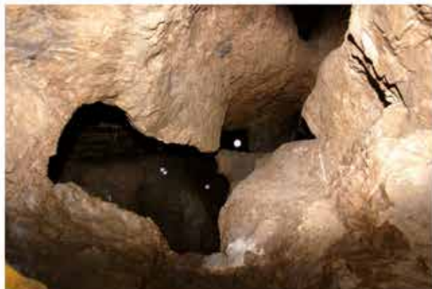
Vue de l'intérieur du chantier du Ggoutil, avec cibles pour le scan 3D
