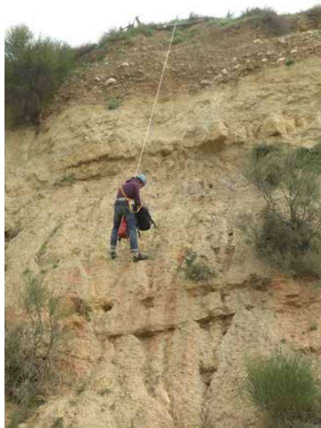
Fig. 1 : prélèvements d'échantillons par un géologue du CEFREM de l'UPVD dans les bancs de calcrètes échelonés sur 15 m de hauteur dans les couches pliocènes d'une falaise de la Canterrane, à Terrats (P.-O.), près de Thuir (cliché M. Martzluff).
