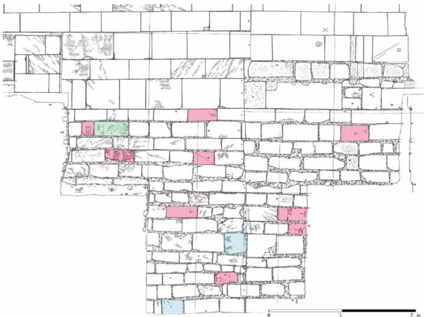
Fig. 2 : relevé pierre-à-pierre des fondations de l'abbatiale dégagées en 2015 avec repérage des pierres en remploi portant des signes lapidaires et des graffiti (H. Hansen, 2015-2016)
