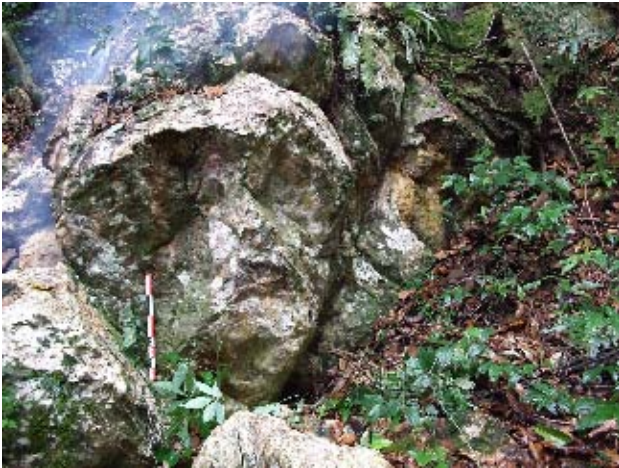
Figure 26 Front de taille d'une attaque au feu, avec une allure caractéristique en gradins renversés, montagne de Bœuf Mort
