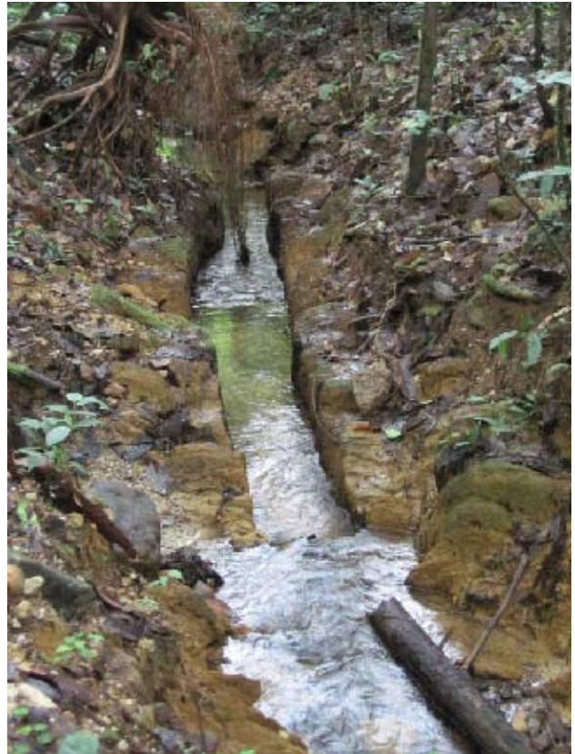
Figure 20 Un « sous-marin », canal creusé dans le substratum et qui joue le rôle du sluice, crique Cajou
