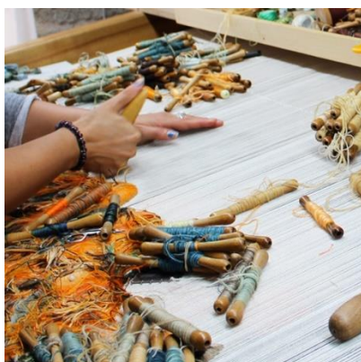
Tassage des fils à l'aide du peigne lors du tissage d'une tapisserie. © Cité internationale de la tapisserie, 2015.
